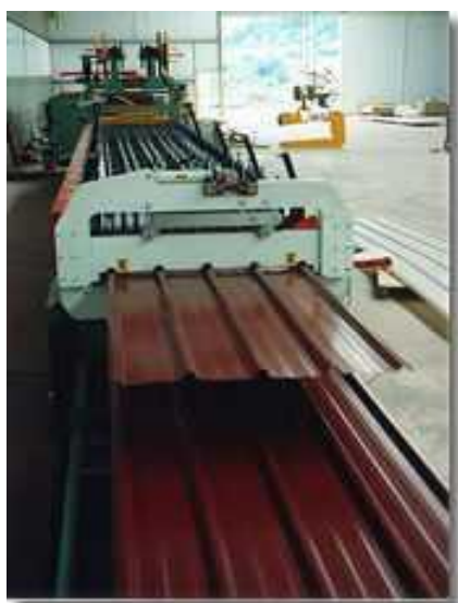
Profilage de Bac acier en usine
